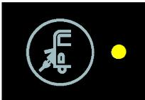
LED Netzkontrolle leuchtet. Die Wohnraumbatterie wird geladen; für Details über die Ladefunktionen siehe Bedienungsanleitung der zugehörigen Stromversorgung EBL ...
